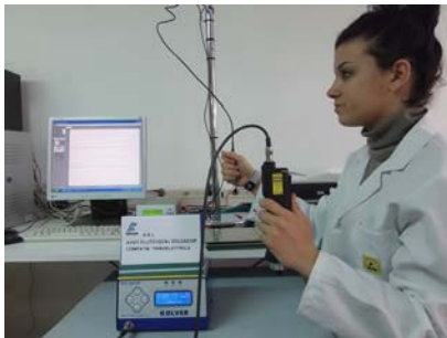
Compatibilità triboelettrica HBM – Operatrice con avvitatore e sonda nelle mani
